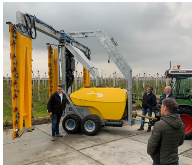
Drierijige bomenspuit KWH Magistralis heeft 99% driftreductie en kan de afgifte per dop aansturen.
