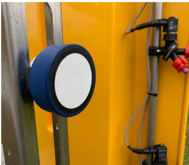
Het spuitsysteem van KWH kan voorzien worden van BBLeap-gatdetectiesensoren: het systeem spuit dan alleen waar blad is.
