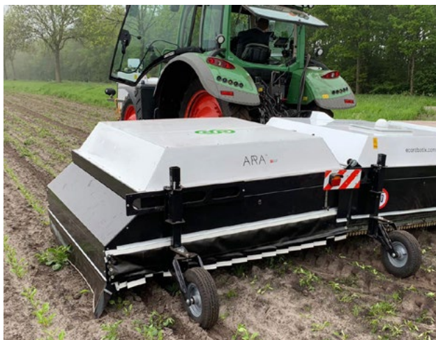
Spotsprayer EcoRobotix ziet volvelds onkruid met camera's, AI en algoritmes. Het systeem bespuit vervolgens ieder onkruidplantje.
