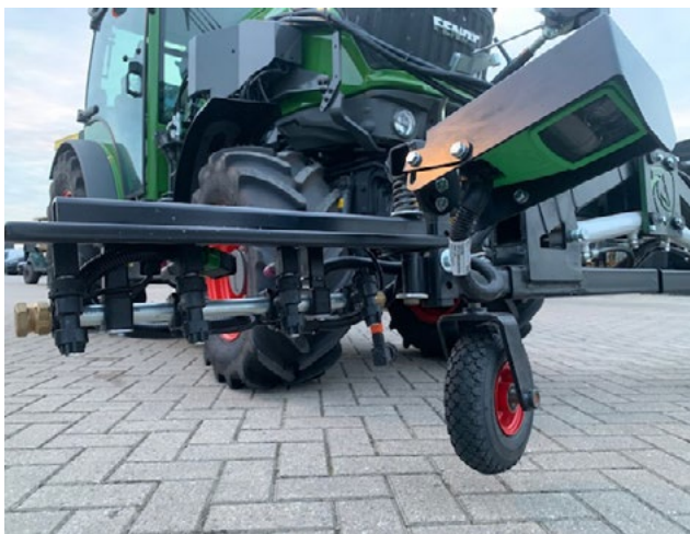
Spotsprayer Weed-It Quadro detecteert onkruid met sensoren.
